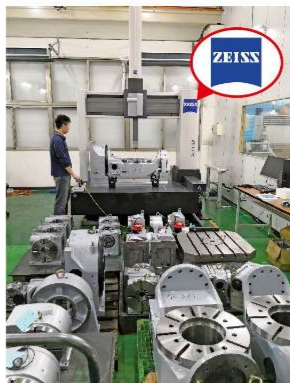
三次元 (三座標) 檢測儀 檢測 幾何精度
