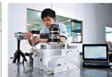
雷射 (激光) 測量儀 檢驗分度盤 分割精度
