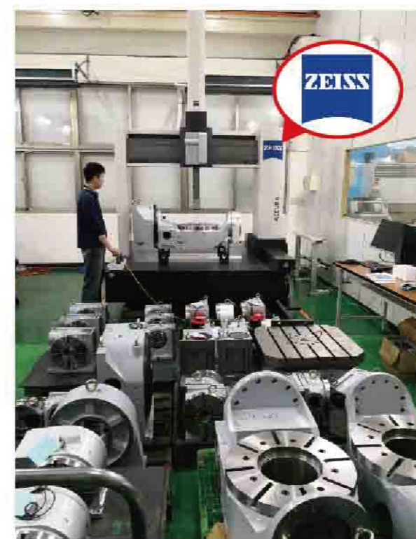
三次元(三坐标)检测仪 检测几何精度
