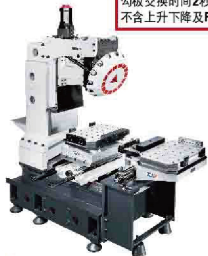
▲ CURC500x700 用于C型立加机或钻攻中心机
