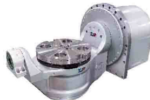
FAD-400HS-AD500i-420 (此照片盘面为非标, 标准盘面 为8条放射状T型槽)
